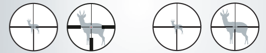
* Záměrný kříž v přední ohniskové rovině (1) * Záměrný kříž v zadní ohniskové rovině (2)
